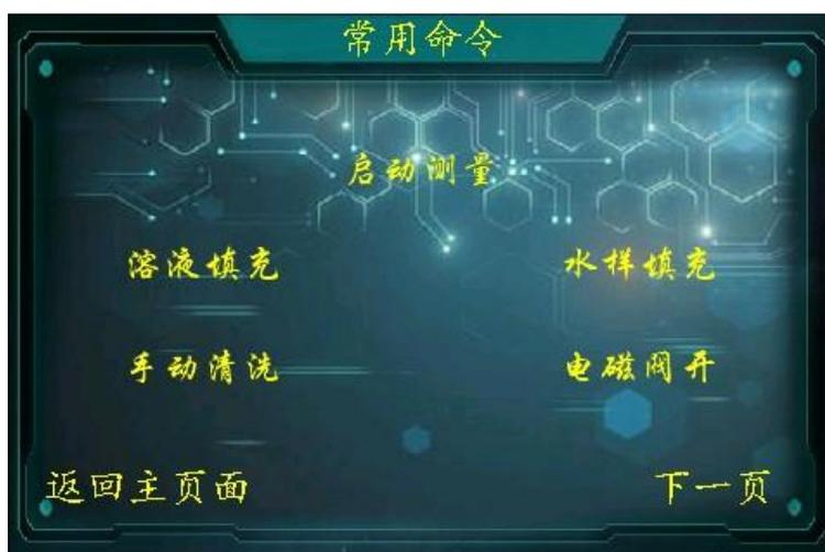
此界面为启动命令界面，可以进行启动测量、溶液填充、水样填充、手动清洗、电磁阀开关操作。
