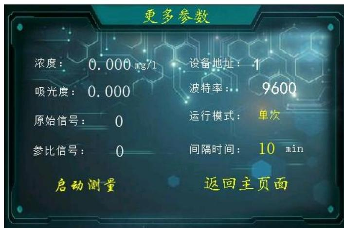
此界面显示详细的测量信息，包括浓度、吸光度、测量信号、参比信号、地址、波特率、运行模式和间隔时间。可对运行模式和间隔时间进行修改。可直接点击启动测量按钮，进行水样测量。
