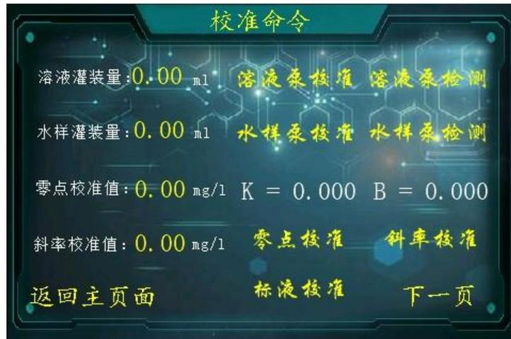
此界面为校准设置页面，可对灌装量、校准值进行设置，对泵进行校准与检测，进行零点校准与斜率校准。读取当前的 K 和 B 值。
